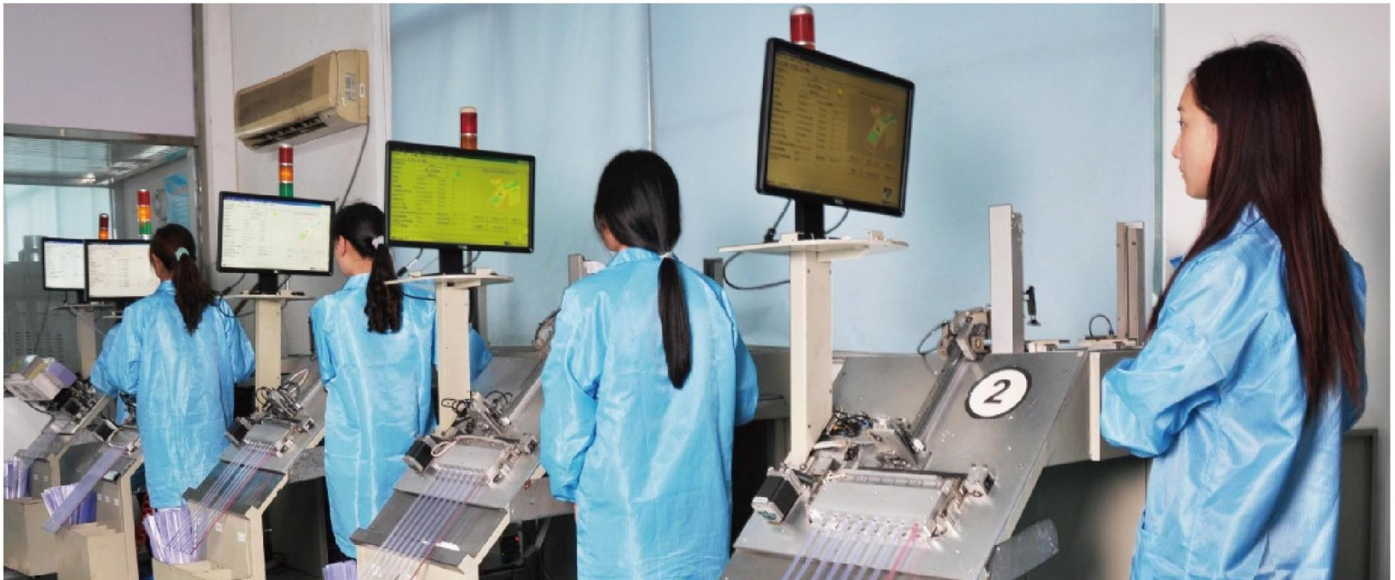
**Мы используем 8-комплектную машину для программирования печатных плат, и можем записывать необходимую программу прямо на чип, сокращая при этом срок разработки продукции**
