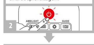
O transmissor do controle remoto original a ser estudado está de frente para o transmissor do presente controle remoto, a distância é de 1 cm a 3 cm, não agite, pressione o botão "POWER" do controle remoto, a luz indicadora manterá a luz duradoura após 3 vezes lampejos rápidos, indicando aprendizagem bem-sucedida. Repita 2 a 3 vezes, aprenda outros botões ou reaprenda.
