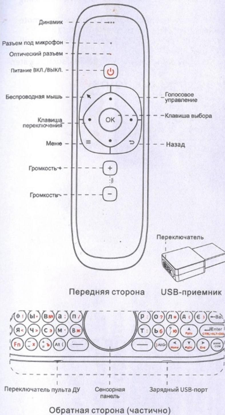
**Fn** : включите функцию, выделенную красными символами, и загорится индикатор Fn. При повторном нажатии для возврата к функции по умолчанию индикатор Fn выключается.
